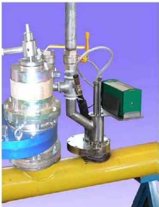
Gruppo Misuratore Gas Metano
