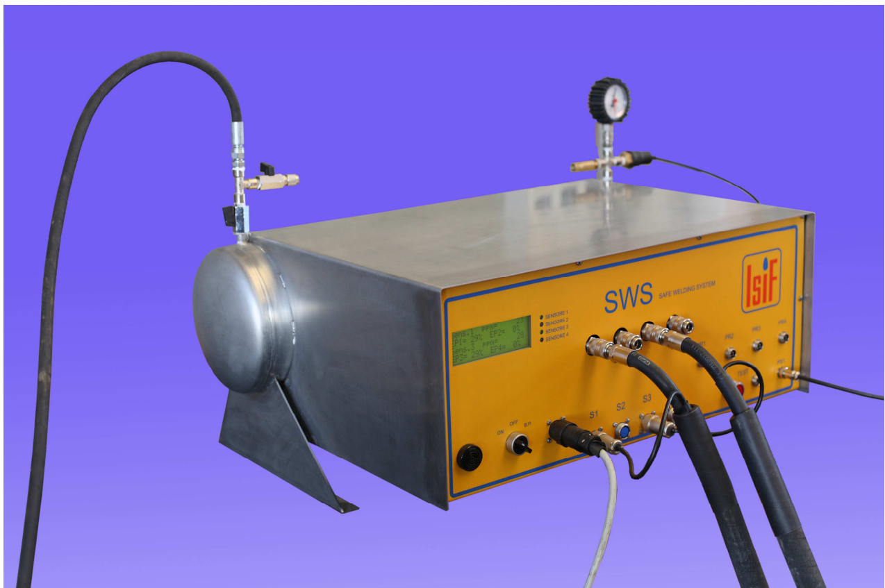
Assieme Collettore Azoto, Centralina Elettronica, cavi e tubazioni di collegamento ai Gruppi Misura
