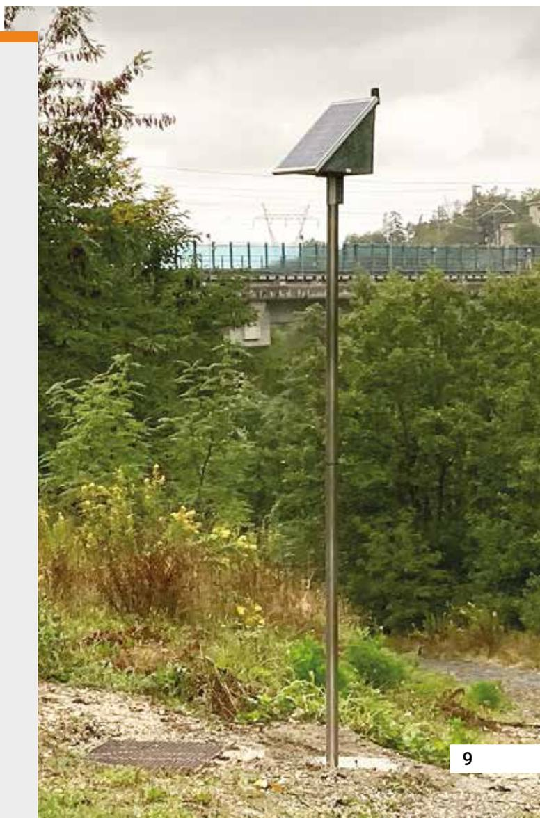
**SENTINEL** è lo strumento adatto a vari campi di applicazione e impiego grazie alla sua capacità di monitorare torsioni, allungamenti, estensioni e compressioni.
